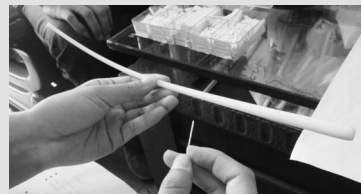
△制造微孔笔尖的特殊模具和微孔笔尖成品
