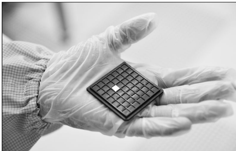
放在手心方型器皿里的小“亮片”就是微电子学院用半浮栅晶体管制造出的测试芯片。
