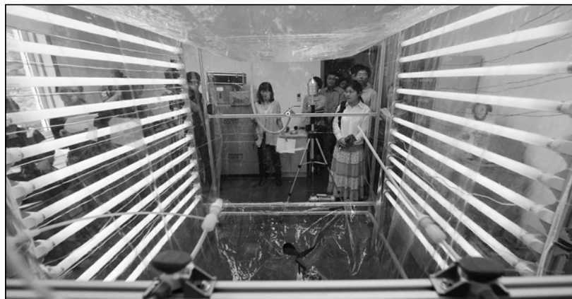
环境工程与科学系用实验装置模拟大气环境,分析 PM2.5 的构成。
