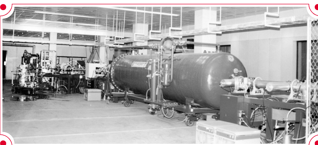
9SDH-2 型(92×3 MeV)串列加速器从 1987 年 9 月正式投入运行,至今已安全服役 30 多年,目前整套系统依然保持良好的工作状态。
